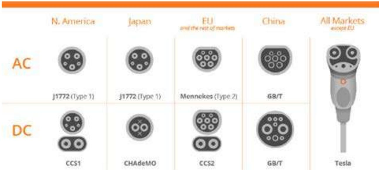
**Figura 22:** Estándares para conectores y puertos de carga de vehículos eléctricos.
