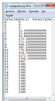
**Figura 7.** Formato del archivo de la curva de potencia del fabricante.
