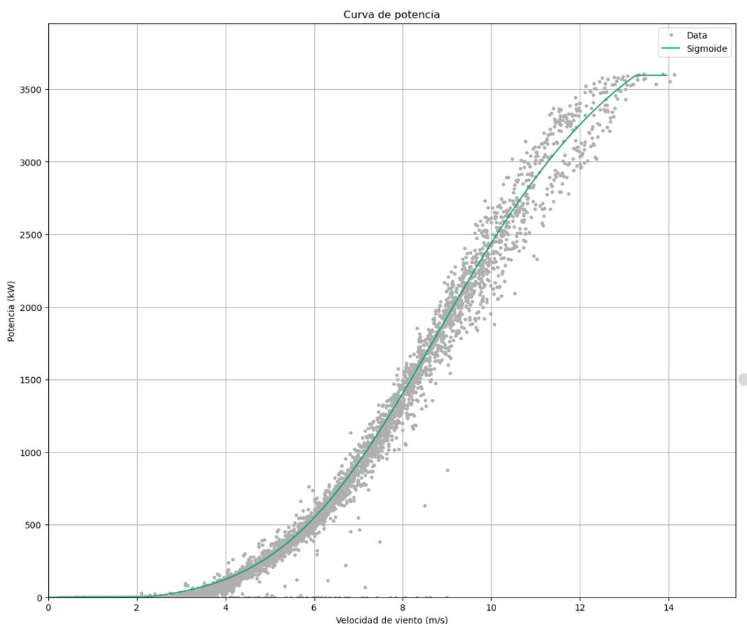
**Figura 8.** Curva de potencia media aproximada con la función de Richards de los datos de una turbina eólica ejemplo en operación.
