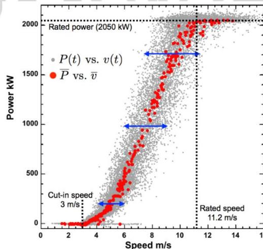
**Figura 4.** Datos de operación de una turbina eólica ejemplo, potencia activa (kW) versus velocidad de viento (m/s),  $\bar{P}$  y  $\bar{v}$  corresponden a la curva de potencia media. Gráfica tomada de *Bandi et al* [5].
