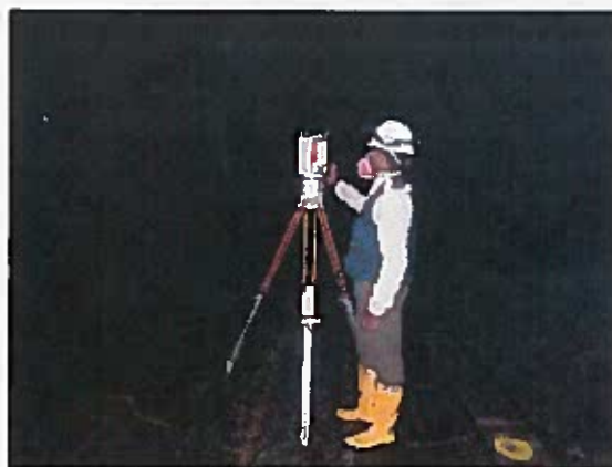
Figura 3.3. Levantamiento subterráneo con escáner laser Fuente: IIGE, 2018 Elaborado por: Marcelo Calderón Viveros
