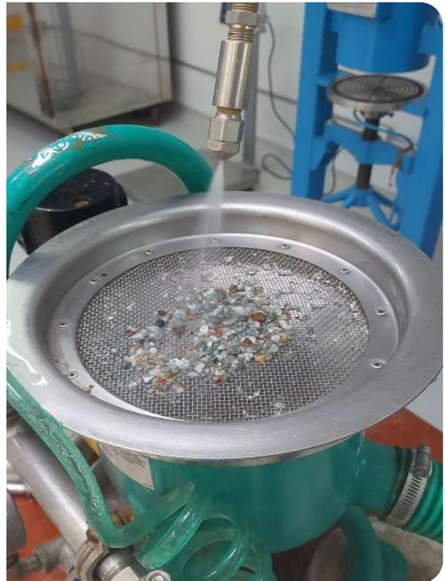
El objeto del ensayo es determinar el comportamiento del mineral a la concentración centrífuga. Se sugiere contar con un análisis mineralógico previo. Se debe realizar análisis a la concentración de oro de los concentrados y relaves.
