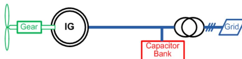
Figura 10 Generador Asíncrono con banco de capacitores
