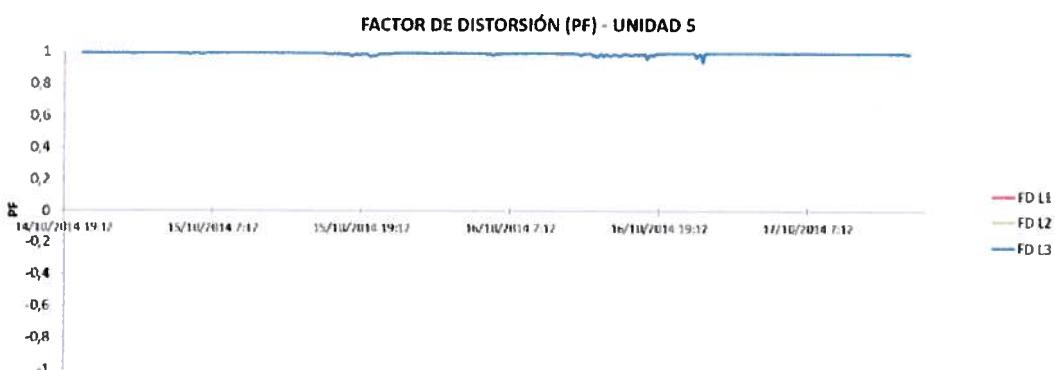
Figura 11. Factor de distorsión producido en el aerogenerador N° 5 de Villonaco.
