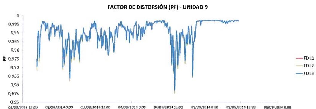
Figura 14. Factor de distorsión producido en el aerogenerador N° 9 de Villonaco.
