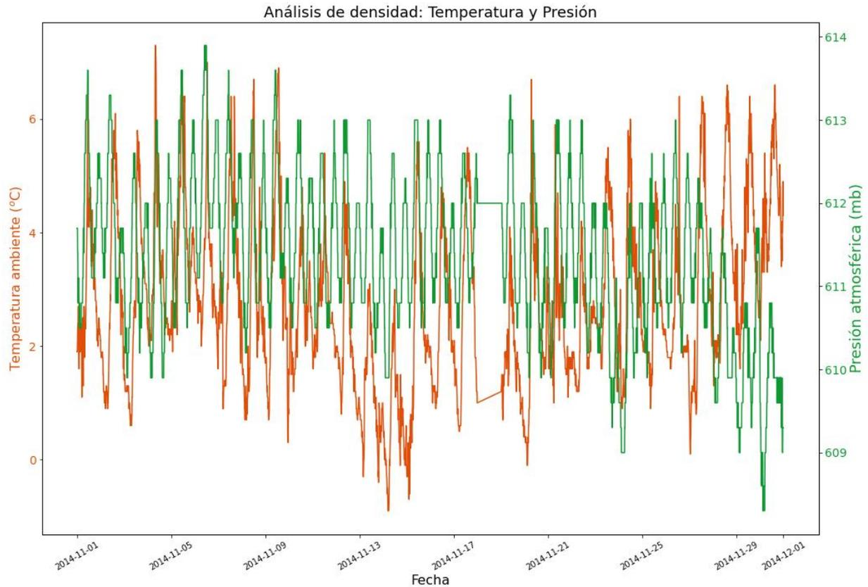
**Figura 2.** Presión atmosférica y temperatura ambiente versus tiempo, analizado con la herramienta de “Densidad del aire” de WAYREapp.
