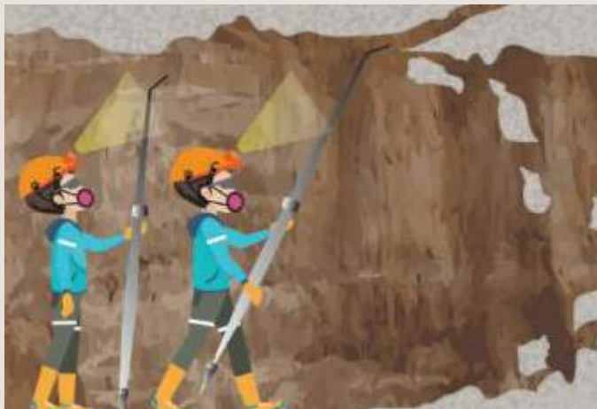
Desquinche en galerías utilizando el equipo de protección personal y barretillas
